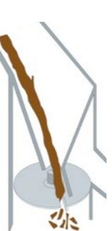
Větve jsou postupně odkrajovány dvěma noži umístěnými na rotujícím talíři s vysokými otáčkami.
