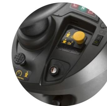
Traktory řady Estate a Tornado mají elektromagnetické zapínání sečení. Jedním tlačítkem snadno zapnete nebo vypnete sečení.
