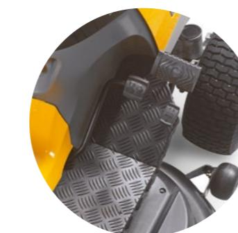
Všechny traktory STIGA (s výjimkou traktoru Estate 384 M) mají hydrostatickou převodovku. Jednoduchým sešlápnutím pedálu plynule měněte pojedovou rychlosť vpřed nebo vzad.
